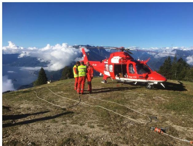
Ausgelegte Windenverlängerung (Foto D. Bieri)
