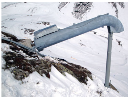
Les tubes Gazex peuvent être utilisés par n'importe quel temps.
