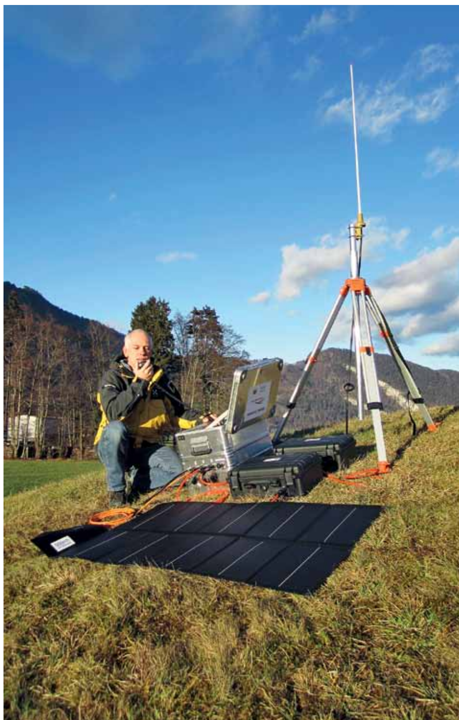
Montée et prête à l'emploi : la valise en aluminium avec l'émetteur et le récepteur, l'antenne ainsi que deux boîtiers comportant des batteries plomb-gel et le panneau solaire. Photo : mäd
