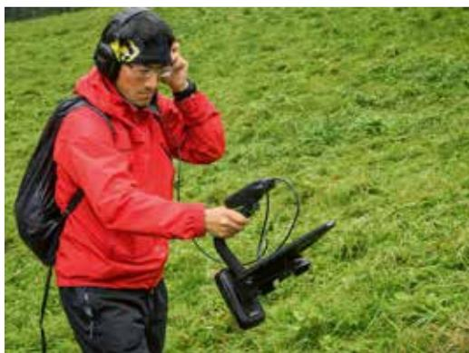
L'appareil de détection de « NeoSoft SAR » est capable de localiser les téléphones mobiles.
