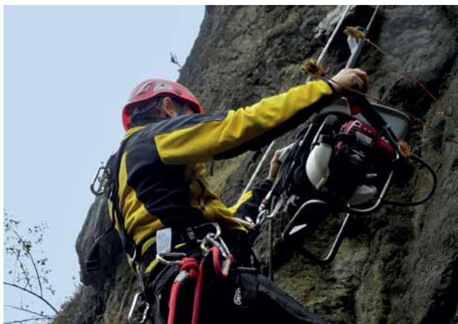
Theo Maurer teste le nouveau treuil avec moteur quatre temps intégré. Les possibilités d'utilisation du « Power Seat » ne manquent pas dans le domaine du sauvetage.
