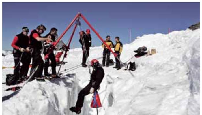
De l'électricité pour remplacer l'air comprimé : les opérations de sauvetage en crevasse avec le trépied Jelk vont devenir plus faciles et plus sûres. L'électricité est produite par un générateur.
